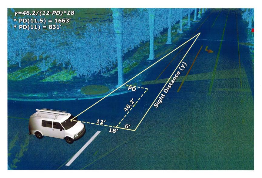
FROM 12 FEET BACK OF FOG LINE, DRIVERS ON ELM CAN SEE MORE THAN 700 FEET DOWN E. LAS PALMAS
